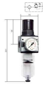
sobald der Eingangsdruck unter den min. Eingangsdruck fällt, öffnet das Ablassventil automatisch. Durch Festdrehen der Ablassschraube kann die halbautomatische Ablassventilöffnung verhindert werden.
