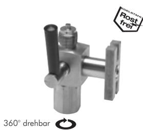
Um Druckmessgeräte zu schützen, ist es zweckmäßig, einen Absperrhahn in die Zuleitung einzusetzen. Der Hebel kann auf Durchgang, Absperrung oder Absperrung mit Entleerung gestellt werden. Bei Stellung „Absperrung mit Entleerung“ gelangt das Volumen vom Absperrhahn bis zum Druckmessgerät in die Atmosphäre.
