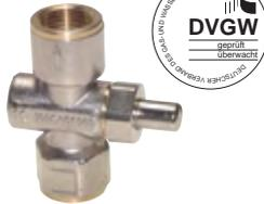
Dieser Manometerdruckknopfhahn wird zur punktuellen Druckmessung verwendet. Das Manometer ist bei unbetätigtem Hahn drucklos. Erst durch Herunterdrücken des Druckknopfes wird das Manometer unter Druck gesetzt und zeigt den Systemdruck an. Nach Loslassen des Knopfes erfolgt die Systemtrennung automatisch und das Manometer wird druckentlastet.
