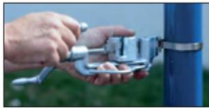
Band in das Spannwerkzeug seitlich einführen, Excenterhebel andrücken und durch Drehen der Kurbel Schelle anziehen. Die maximale Spannung ist erreicht, wenn das Band nicht mehr unter der Schleufe durchzieht (lässt sich durch Auflegen eines Fingers leicht „erfühlen“).
