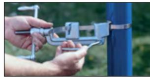
Nach Erreichen der erforderlichen Spannung das Werkzeug langsam über die Schleufe biegen. Dabei gleichzeitig die Kurbel ca. eine halbe Umdrehung lösen, um Spannungsverlust und Reißen des Bands zu vermeiden. Um das Band abzuschneiden, Schneidhebel ruckartig ziehen.
