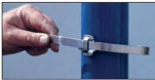
Schleufe mit den Ohren zum Bandende auf das Band ziehen. Schelle formen und Band auf Band legen. Schleufe über beide Bänder ziehen und das Bandende ca. 30 mm unter die Schleufe biegen. Bei hoher Belastung der Schelle (z. B. bei Schlauchbindung) Band zweimal durch die Schleufe ziehen.
