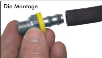
Schlauch rechtwinklig abschneiden. Zur leichten Montage Nippel mit Seifenlösung benetzen.
