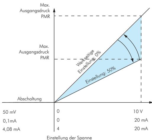
Die Spanne kann maximal auf 100 % PMR eingestellt werden. Es ist nur eine Reduzierung möglich.
