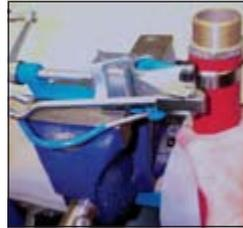
Stecken Sie den Schlauch durch die Schelle und drehen die Kurbel des Spannwerkzeuges nach rechts bis die gewünschte Spannung erreicht ist. Wenn sich das Band nicht mehr durch die Schlaufe zieht, ist die maximale Zugkraft erreicht.
