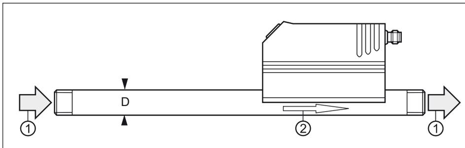
Bauen Sie die Messstrecke so ein, dass Durchflussrichtung (1) und Markierungsfeil (2) in dieselbe Richtung weisen. Bei Störungen an der Einlaufseite werden zusätzliche Beruhigungsstrecken (B) empfohlen:
