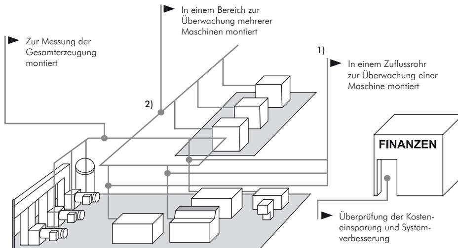
Mit dem Druckluftverbrauchszähler LVM bietet man dem Anwender eine kostenkünstige Möglichkeit, den aktuellen Druckluftverbrauch präzise zu messen. Hierfür ist der Sensor werkseitig in einer Messstrecke montiert und abgeglichen.
